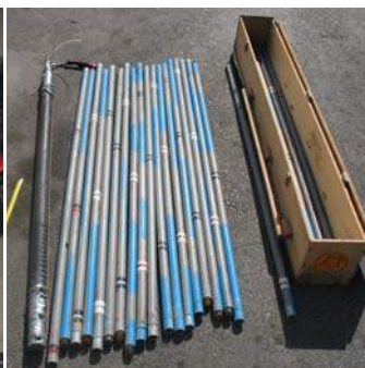
foto 2– sensore a 10 componenti con aste guida
