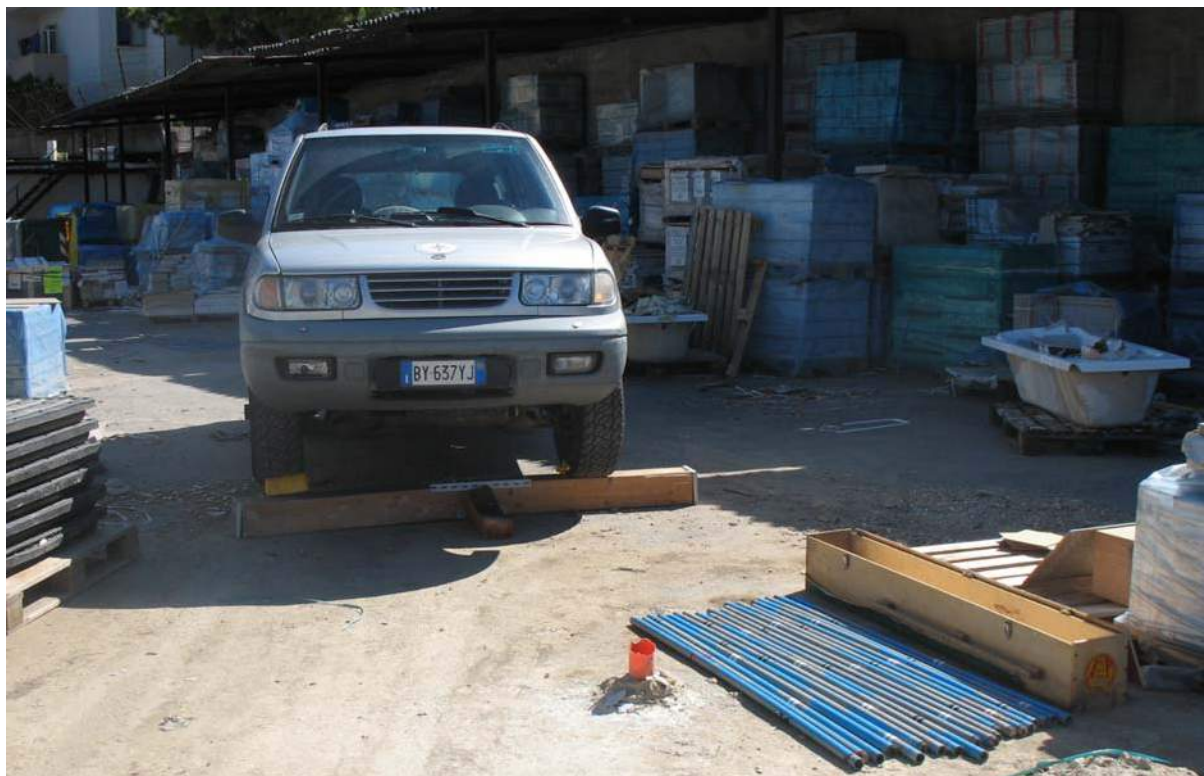
foto 7: trave di legno ancorata con piastra di battuta
