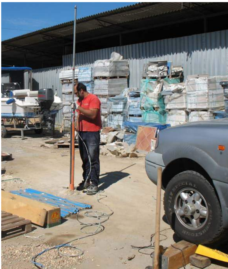
foto 6: geofono da foro a 10 sensori con asta guidata
