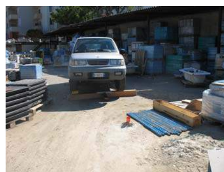
foto 3– trave di battuta ancorata (base del triangolo isoscele il cui vertice è costituito dal foro di misura)
